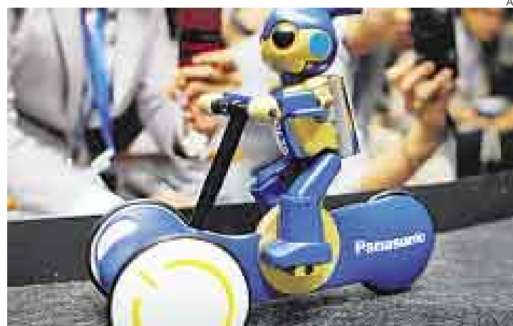
PEQUEÑO. El robot cabe en la palma de una mano. Usará sensores infrarrojos para guiar su camino cuando recorra el circuito francés.
